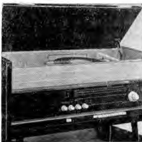
ВЭФ — РАДИО 65 — сетевая радиолa. Ее приемник работает в диапазонах длинных, средних, коротких и ультракоротких волн. Чувствительность в длинноволновом и средневолновом диапазонах 30—60 мкВ, в коротковолновом 40—80 мкВ, в ультракоротковолновом 2—5 мкВ. Диапазон звуковых частот, воспроизводимых в тракте АМ, 60—7000 Гц, а в тракте ЧМ 60—12 000 Гц. Питается от сети переменного тока напряжением 127 и 220 В. Разработчик и изготовитель — завод ВЭФ г. Рига.
