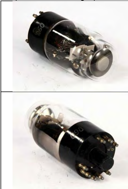
63. Optiskās noskaņošanas indikators EM1 un tā cokola daļa
