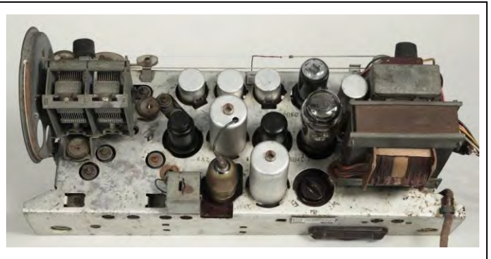
43. Detaļu novietojums uz uztvērēja Rīga 6 šasijas
