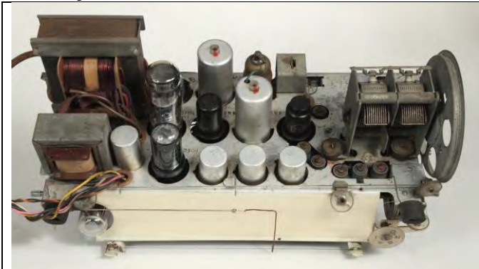
43. Detaļu novietojums uz uztvērēja Rīga 6 šasijas
