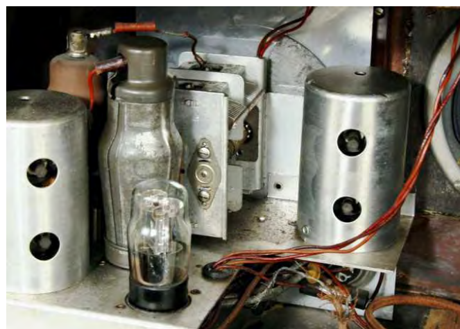
Uztvērējs VefsUPER B306 ar lampu KL5 uztvērēja gala pakāpē. Eksportam uz Ziemeļeiropas valstīm VefsUPER B306 skalā nav uzraksta "Rīga". Rīgas raidītājs uztverams vietā starp uzrakstiem "Fredrikst" un "Rjukan".
