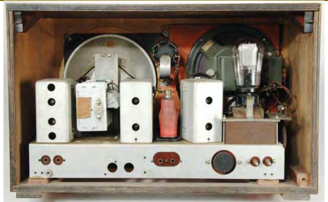
Uztvērēja Vefsuper M507 šasija ar lampām EK2; EBF2; EFM1; EL3N; AZ1 ievietota taisnstūra finierētā uztvērēja Vefsuper MD/40 kastē.
