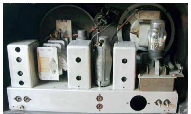
Uztvērēja Vefsuper M507 šasija ar lampām EK2; EBF2; EFM1; EL3N; AZ1 ievietota taisnstūra finierētā uztvērēja Vefsuper MD/40 kastē.
