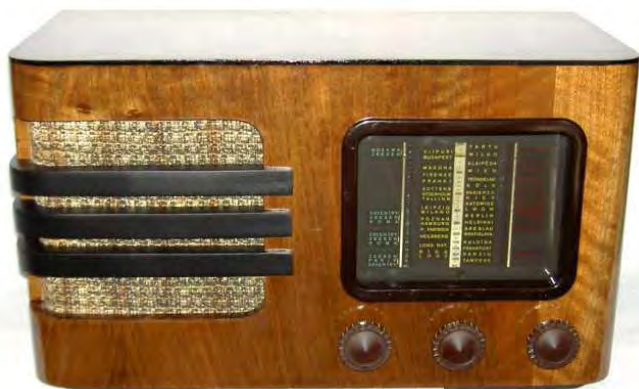
Uztvērēja Vefar 2MD/38 modifikācija ar filtru vietējā raidītāja izslēgšanai - izgatavoti uz atsevišķu pieprasījumu.
