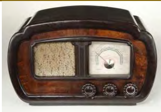
Uztvērējs VefsUPER B306 ar lampu KL5 uztvērēja gala pakāpē. Eksportam uz Ziemeļeiropas valstīm VefsUPER B306 skalā nav uzraksta "Rīga". Rīgas raidītājs uztverams vietā starp uzrakstiem "Fredrikst" un "Rjukan".
