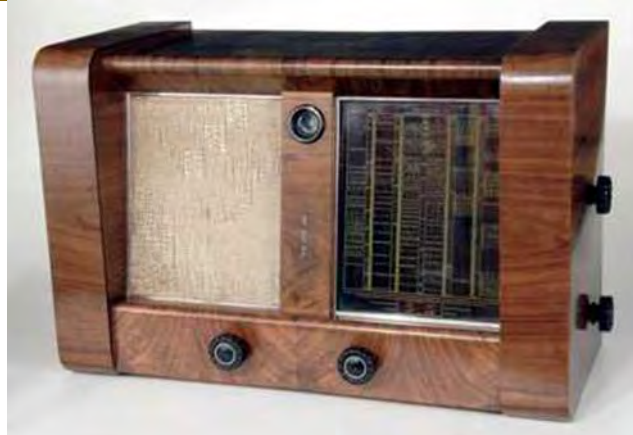
Uztvērējs VefsUPER B306 ar lampu KL5 uztvērēja gala pakāpē. Eksportam uz Ziemeļeiropas valstīm VefsUPER B306 skalā nav uzraksta "Rīga". Rīgas raidītājs uztverams vietā starp uzrakstiem "Fredrikst" un "Rjukan".
